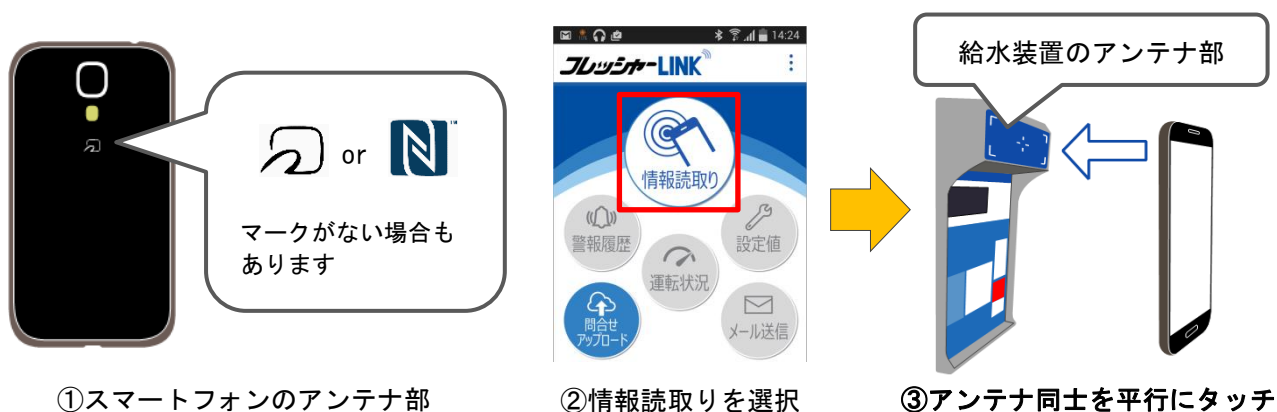
図 17 給水装置との通信方法
