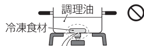
冷凍食材を鍋の底面中央(温度センサーの接触位置)に密着させない
